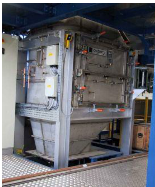
2.11-сурет - "Бұрку атомизация" қондырғысы: сыйымдылығы 80 кг дейін. Оксфорд университеті
